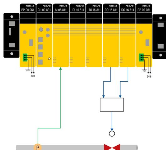
Применение в контроллере REGUL R500S безопасного канала передачи данных для обмена данными между контроллерами, а также модулями в составе ПЛК позволяет использовать стандартные средства коммуникации, при этом разделив данные, участвующие и не участвующие в функциях безопасности.
