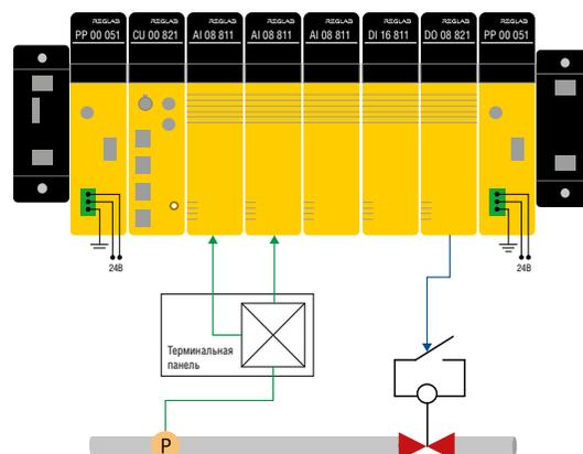
Рис. 7. Резервированная сборка модулей вывода R500S
