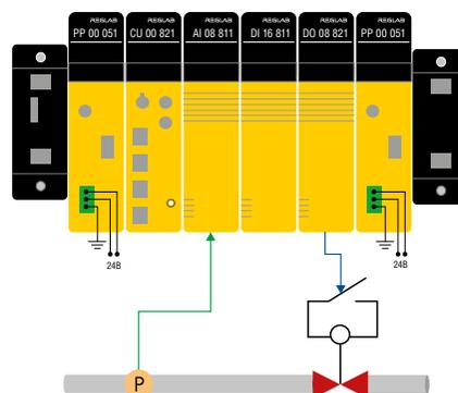
Рис. 6. Резервированная сборка модулей ввода R500S
